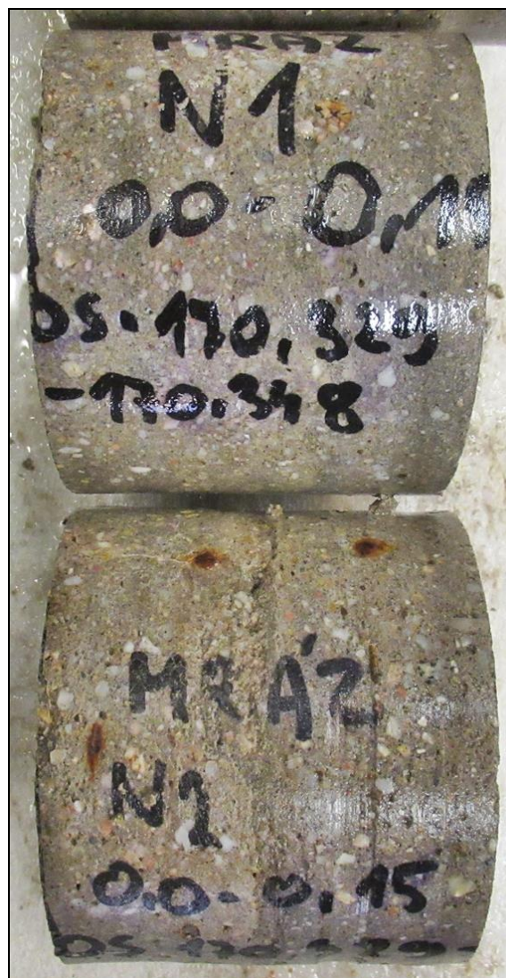
Foto 11: Pohled na vzorky N1 a N2 (170,329-170,348) po zkoušce mrazuvzdornosti – 75 zatěžovacích cyklů
