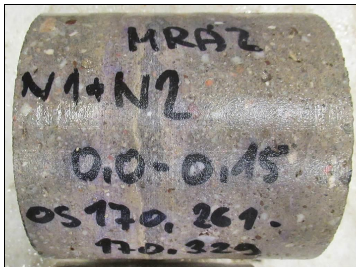
Foto 10: Pohled na vzorek N1+N2 (170,261-170,329) po zkoušce mrazuvzdornosti – 75 zatěžovacích cyklů
