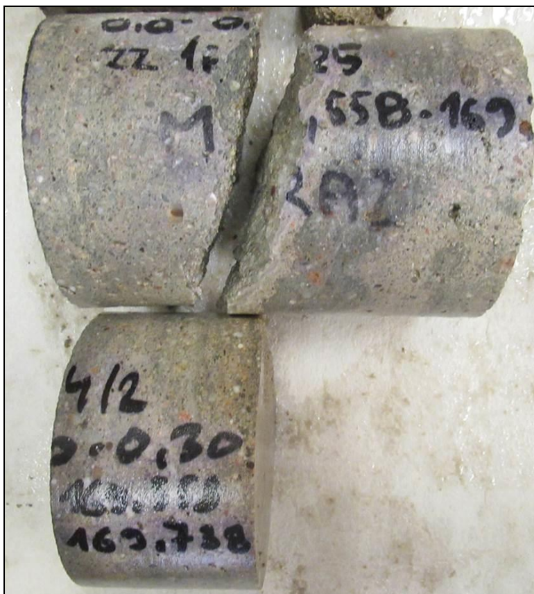
Foto 8: Pohled na vzorky N3 a N4/2 (169,558-169,738) po zkoušce mrazuvzdornosti – 75 zatěžovacích cyklů
