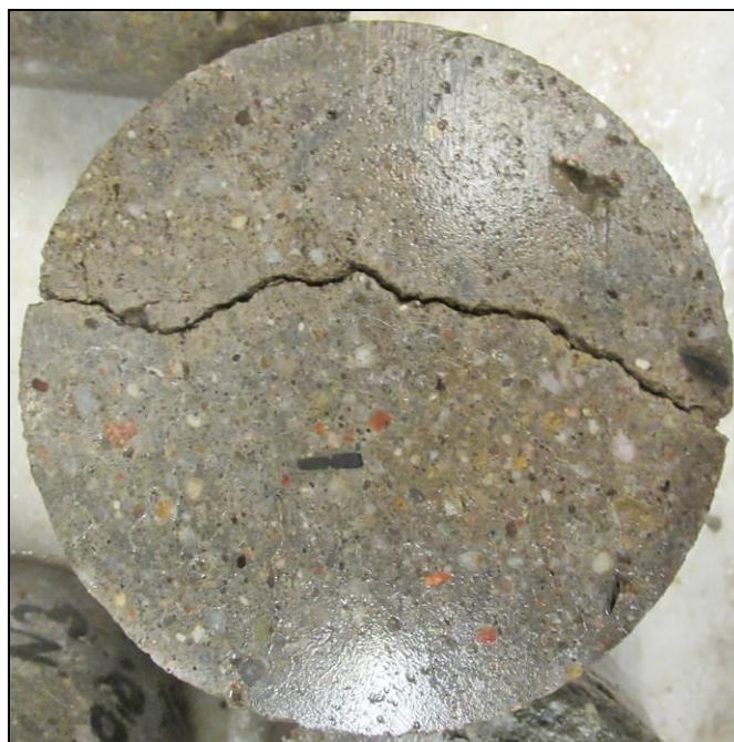
Foto 7: Pohled na vzorek N2 (169,558-169,738) – rozšíření trhliny na lici vzorku po zkoušce mrazuvzdornosti – 75 zatěžovacích cyklů
